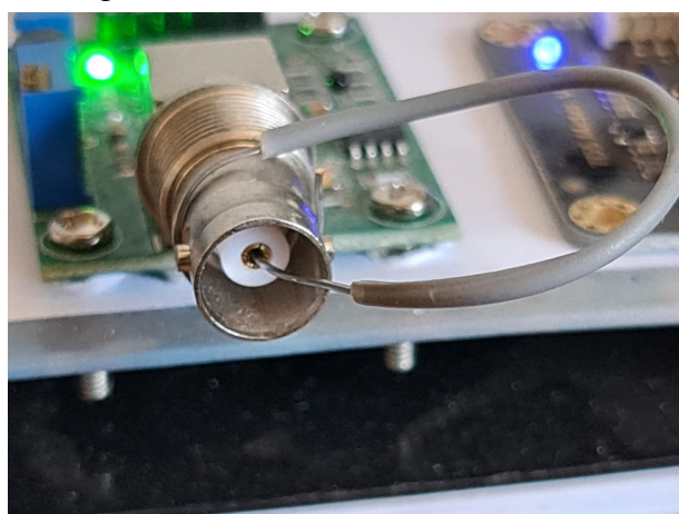
Figura 27: Entrada coaxial curto-circuitada
