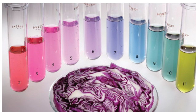
Figura 22: suco de repolho roxo em diferentes soluções, método fotométrico
