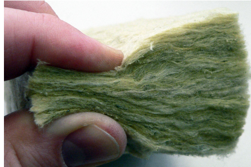
Figura 2: Manta de lã de rocha vista de perto
