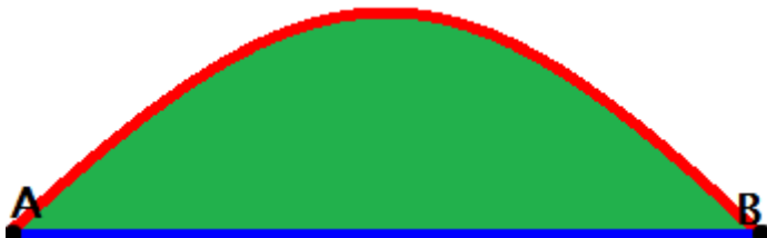
Figura: A e B são os pontos, a distância desenhada em azul é a distância euclidiana e a distância desenhada em vermelho é a distância geodésica.
